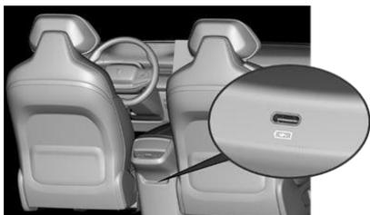
Ubicado debajo de la salida de aire acondicionado trasera, los ocupantes traseros pueden usar dispositivos con puerto Tipo-C para cargar.
