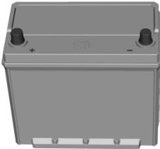
Cuando instale la batería, conecte primero el terminal positivo y luego el terminal negativo, y apriételos con una llave de tubo M10.
