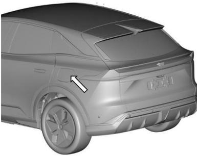
Desbloquee el vehículo y presione la tapa del puerto de carga para que se abra, luego retire la cubierta a prueba de polvo del enchufe de carga lenta.
