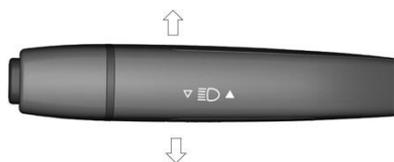
**Luces largas:** Después de encender las luces de cruce, empuje hacia adelante la palanca de control de luces para cambiar de luces de cruce a luces largas. Para volver a las luces de cruce, vuelva a empujar la palanca hacia adelante.
