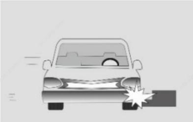
Las siguientes situaciones pueden resultar en que el airbag lateral no se despliegue, incluso si la velocidad de colisión del vehículo es alta, pero la determinación real de si se despliega el airbag debe basarse en si la desaceleración general del vehículo durante la colisión cumple con las condiciones de despliegue.
