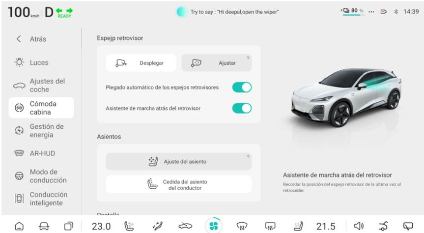
3. Toque el botón "Desplegar" para desplegar los espejos retrovisores exteriores. Aparecerá un mensaje en la parte inferior de la pantalla de control central indicando "Espejos retrovisores desplegados".
