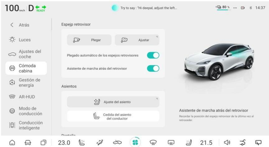
2. En la interfaz de ajuste de los espejos retrovisores exteriores, seleccione el espejo retrovisor exterior que desea ajustar, luego utilice los botones de arriba + , abajo - , izquierda ⏪ y derecha ⏩ en el lado derecho del volante o las flechas virtuales en la pantalla de control central para ajustar la posición de "Arriba", "Abajo", "Izquierda" y "Derecha" del "Espejo retrovisor izquierdo" y "Espejo retrovisor derecho".
