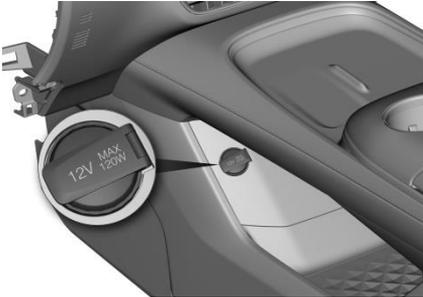
La toma de corriente del apoyabrazos central proporciona una fuente de alimentación de 12V CC para dispositivos con una potencia de hasta 120W.
