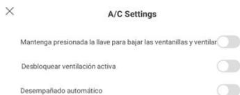
Ventilación al bajar las ventanillas con la llave: al mantener presionado el botón de desbloqueo con el vehículo cerrado, el sistema de aire acondicionado se activará con un flujo de aire máximo y las ventanillas se bajarán. Este modo se desactivará automáticamente después de un tiempo y también se detendrá si se abre una puerta.
