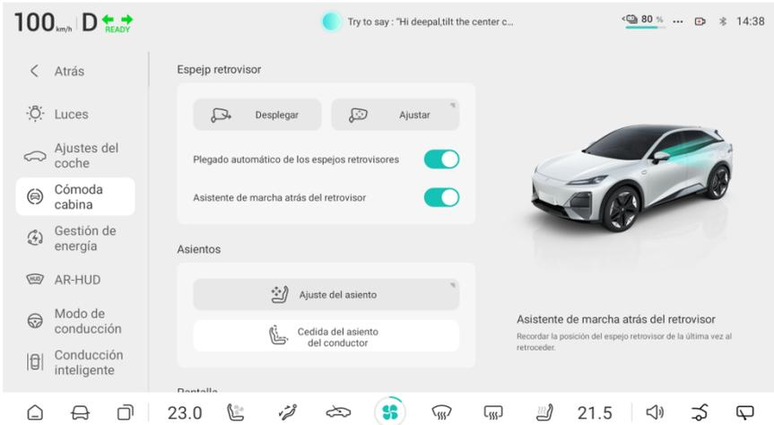
2. Toque el botón "Plegar" para plegar los espejos retrovisores exteriores. Aparecerá un mensaje en la parte inferior de la pantalla de control central indicando "Espejos retrovisores plegados".
