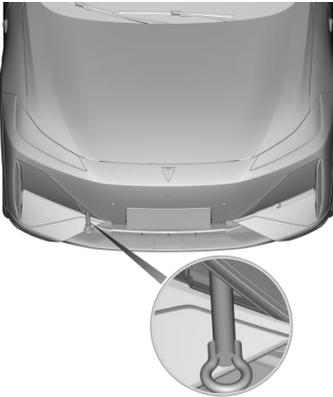
El punto de remolque delantero está debajo del parachoques delantero, a la derecha. Abra la tapa de montaje del gancho de remolque y apriete el gancho para usarlo.
