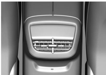
Ajuste de la dirección del flujo de aire: mediante los botones de ajuste vertical, horizontal y lateral, controle la dirección y la apertura y cierre de la salida de aire trasera.
