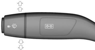
Para cambiar de carril: Gire la palanca de control de luces hacia arriba o hacia abajo para activar el intermitente derecho o izquierdo respectivamente. Después de activado, el intermitente parpadeará tres veces antes de apagarse.
