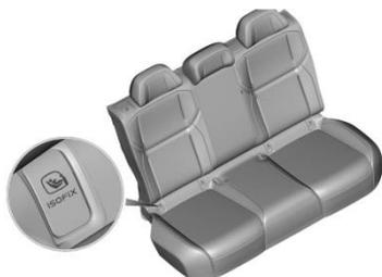
Los puntos de fijación ISOFIX compatibles están instalados en el cuerpo del vehículo. La etiqueta ISOFIX ayuda a identificar rápidamente los puntos de fijación del dispositivo de retención infantil.
