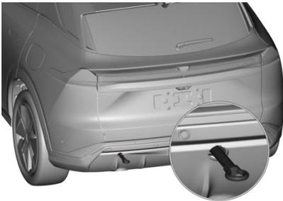
El punto de remolque trasero está debajo del parachoques trasero, a la izquierda. Abra la tapa de montaje del gancho de remolque y apriete el gancho para usarlo.
