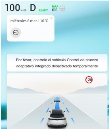
Cuando el IACC se suspende temporalmente, solo se suspende la asistencia de dirección, y el sistema seguirá ayudando al conductor en el control de la aceleración y la desaceleración del vehículo. Una vez que se levanten las condiciones de desconexión temporal, la asistencia en el giro se restaurará automáticamente.
