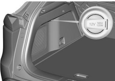
La toma de corriente del maletero proporciona una fuente de alimentación de 12V CC para dispositivos con una potencia de hasta 120W.
