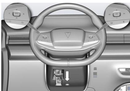
2. Ajuste el volante a la posición deseada.
