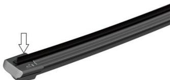
Si los limpiaparabrisas no limpian correctamente, puedes utilizar una esponja suave humedecida con agua para limpiar el borde de goma de los limpiaparabrisas. Primero, limpia el parabrisas y los limpiaparabrisas con un limpiador específico, luego enjuaga con agua limpia.
