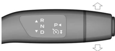
Activación del ACC: Mueva el interruptor de la palanca de cambios hacia abajo una vez.
