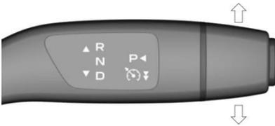
Activación del IACC: Mueva rápidamente la palanca de cambios hacia abajo dos veces.
